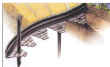
Рис. 7. Вариант закрепления краевых участков мощения с помощью пластикового бордюра
