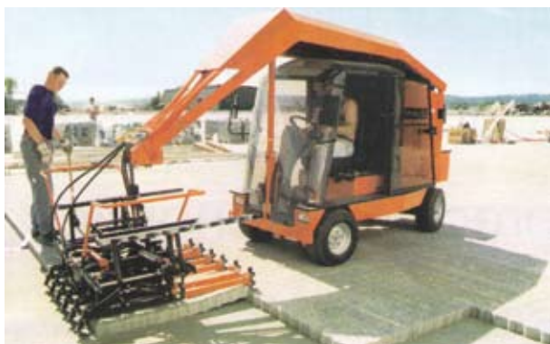
Рис. 39. Механизированные укладчики камней мощения “OPTIMAS” и “ROBOTEC”.
