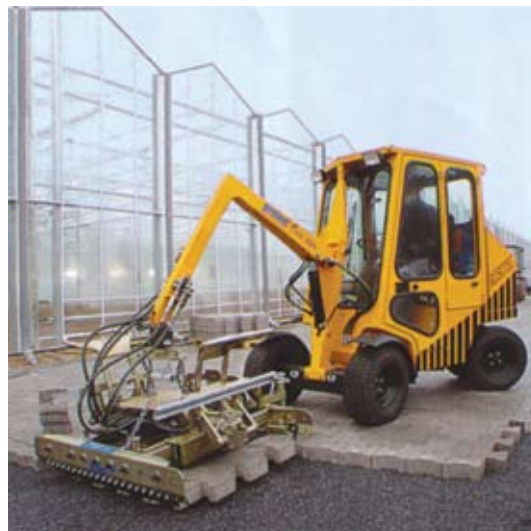
Рис. 39. Механизированные укладчики камней мощения “OPTIMAS” и “ROBOTEC”.
