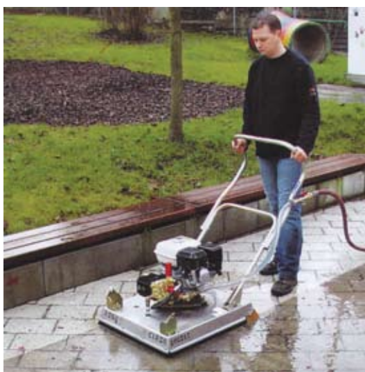
Рис. 43. Моечная машина EC 60 “PROBST”.
