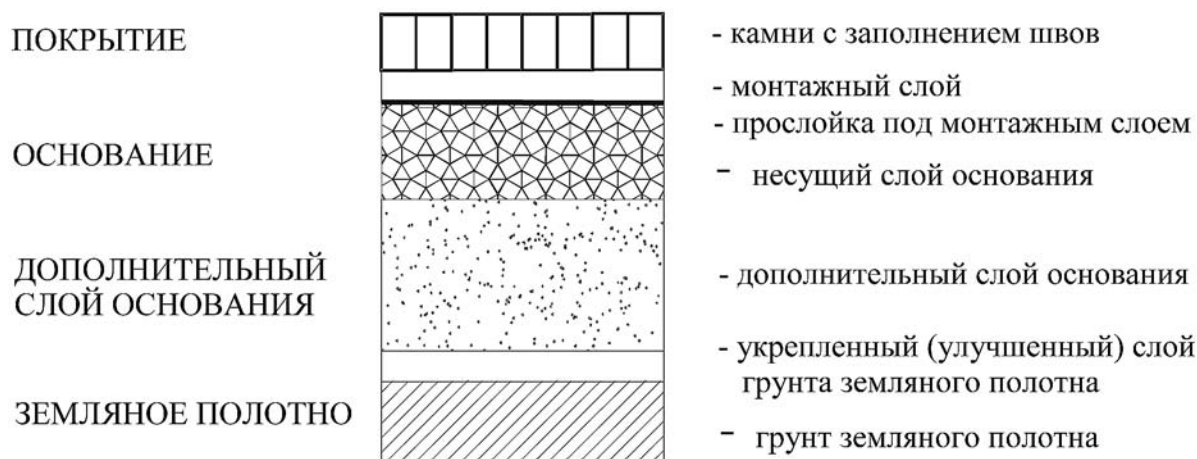
Рис. 9. Принципиальная конструкция дорожной одежды
