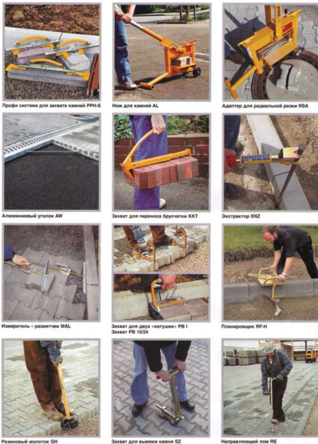
Рис. 42. Вспомогательный инструмент для выполнения работ по мощению.
