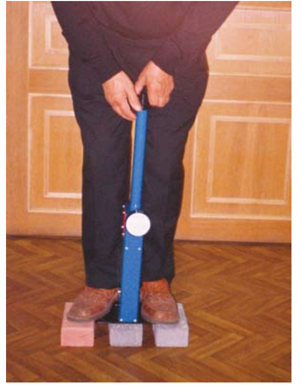
Рис. 2. Процесс измерения коэффициента сцепления лицевой поверхности камней мощения.
