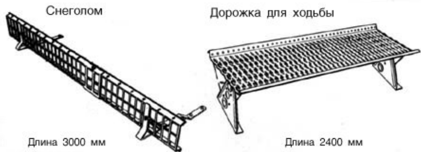
Рис. 82. Элементы безопасности: снегозадержатель и трап
