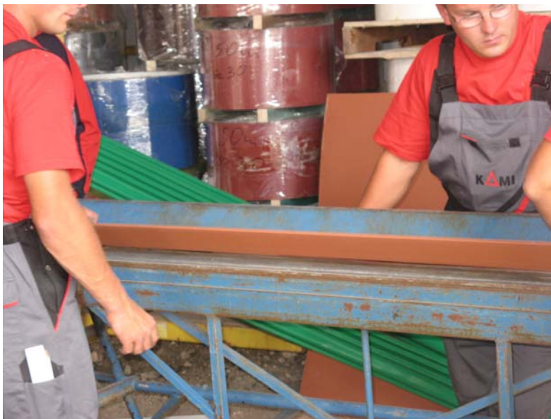
Рис.19. Изготовление планки на ручном гибочном станке
