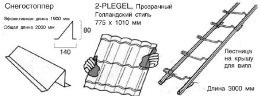
Рис. 81. Элементы безопасности: планка снегоуловителя и лестница
