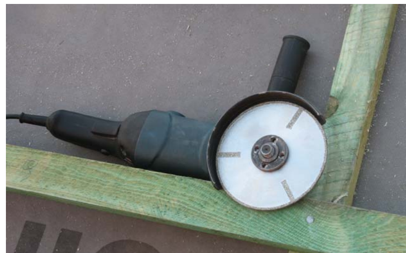
Рис.28. Инструмент для подрезания листов металлочерепицы
