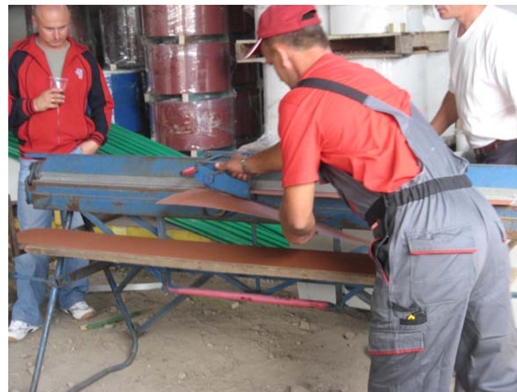
Рис.18. Разрезка плоского листа на штрипсы
