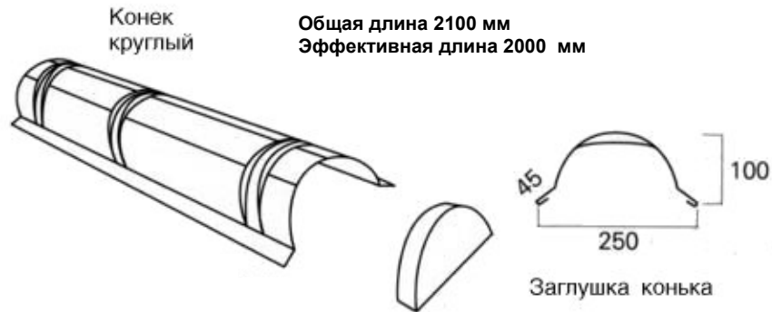
Рис. 78. Планка круглого конька с торцевой заглушкой
