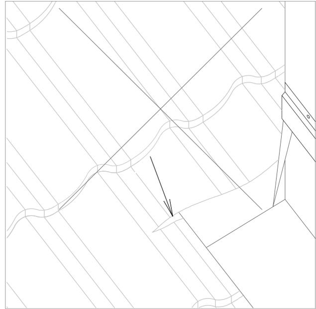
Смонтировав на скате фартук, вы обеспечили проход воды от конька до карниза, минуя трубу.
